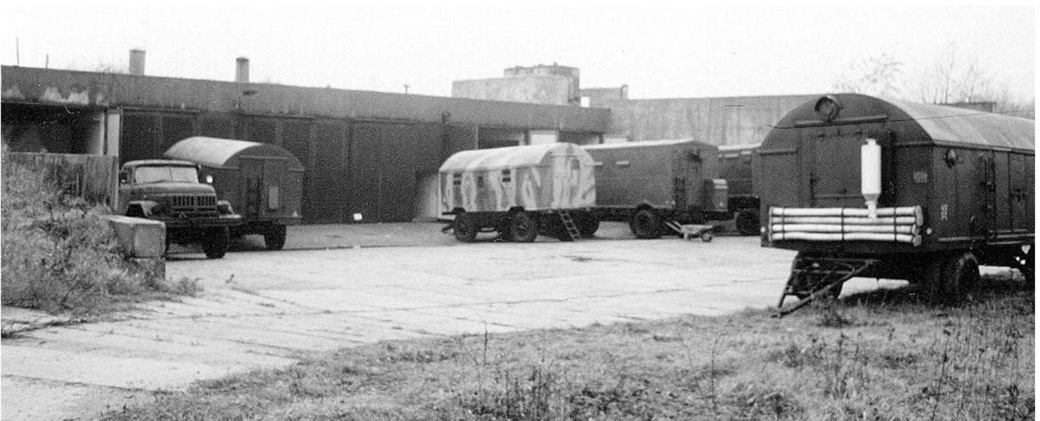
*Der "Mittelpunkt" der FRA-134 im Spätherbst 1990. Die Kabinen sind aus den Boxen herausgezogen worden, das Antennensystem der PW ist abgebaut und verladen. Ganz rechts ein Aggregat ESD-200, dahinter die beiden Kabinen AW und UW. Der Mittelpunkt der FRA-134 mit Gefechtsstand, Unterkünften, Klub, Küche und Sanitäreanlage wurde Anfang der achtziger Jahre neu gebaut.*
