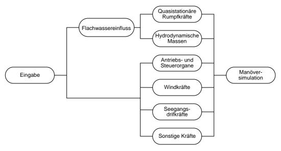
Quasistationäre Kräfte des Rumpfes werden aus archivierten Messdaten oder RANSE-Rechenergebnissen als Funktion der Bewegungskoordinaten durch Regressionsanalyse, siehe Abschnitt 5, gebildet. Modellversuche und RANSE-Berechnungen wurden für drei Referenzschiffe für Tiefund Flachwasser durchgeführt.
